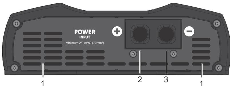
**1 - COOLERS:** Este amplificador possui dois coolers de ventilação interna, e que não podem ser obstruídos. Para perfeito funcionamento, o amplificador deve ser instalado em local seco e arejado. Recomendamos não embutir o mesmo, para que assim o ar circule em toda a extensão interna do produto, assim evitando a atuação da proteção térmica.
