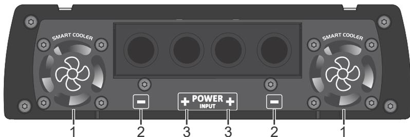
**1 - SMART COOLER:** Este amplificador possui dois coolers de ventilação interna. Controlado por um sistema inteligente (Smart Cooler), o mesmo só funciona em velocidade máxima quando necessário, garantindo maior vida útil do cooler e um funcionamento mais silencioso do seu amplificador. Para perfeito funcionamento, o amplificador deve ser instalado em local seco e arejado, com espaço livre de no mínimo 1" (25mm) de cada lado. A temperatura normal de trabalho deste amplificador é de 65° C.
