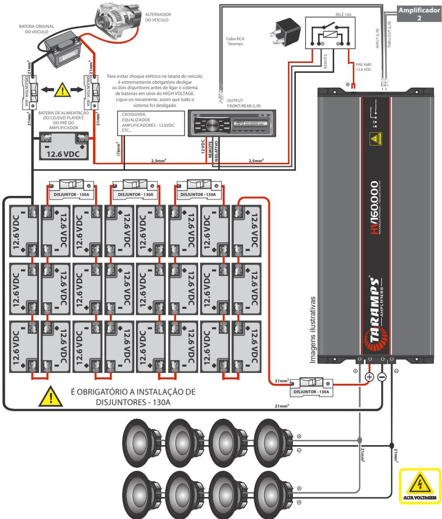
\*Bitolas dos cabos de saída de 21mm<sup>2</sup>, calculado considerando um comprimento máximo de 2m.
