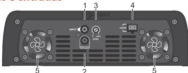
**1 - INPUT:** Conectar à saída RCA do CD / DVD Player, utilizando cabos blindados de boa qualidade para evitar a captação de ruídos. Os sinais das entradas L e R são misturados (adicionados) internamente.
