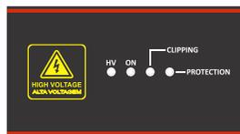
**LED VERDE (HV):** Indica presença de alta voltagem nos terminais de alimentação.
