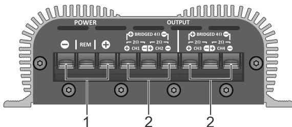
**1 - POWER (Conector de Alimentação):** O terminal (+) do conector, deve ser ligado ao polo positivo da bateria através de um cabo de bitola mínima de 4mm<sup>2</sup>. O terminal (-) do conector deve ser ligado adequadamente no polo negativo da bateria por meio de um cabo de bitola equivalente ao cabo positivo. O terminal remote deve ser ligado á saída REMOTE do CD/DVD Player, por meio de um cabo de 0,75mm<sup>2</sup>.
