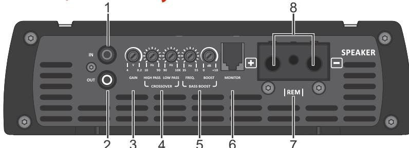
**1 - IN:** Entrada de la señal a ser amplificado. Conectar en la salida RCA del Rádio / Estéreo, utilizando cables blindados de buena calidad para evitar la captación de ruidos.
