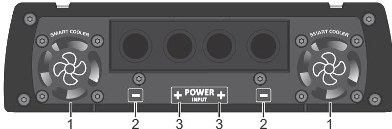
**1 - SMART COOLER:** Este amplificador tiene dos ventiladores de ventilación internos. Para un funcionamiento perfecto, el amplificador debe instalarse en un lugar fresco y aireado con un espacio mínimo de 1" (25 mm) alrededor del disipador para que el calor se propague correctamente. La temperatura de trabajo habitual del amplificador es de 65 °C.
